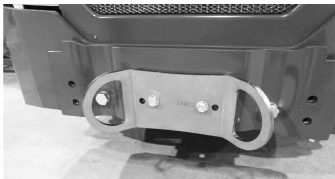
Staffa di ancoraggio A418623 installata sul paraurti posteriore o sul contrappeso
